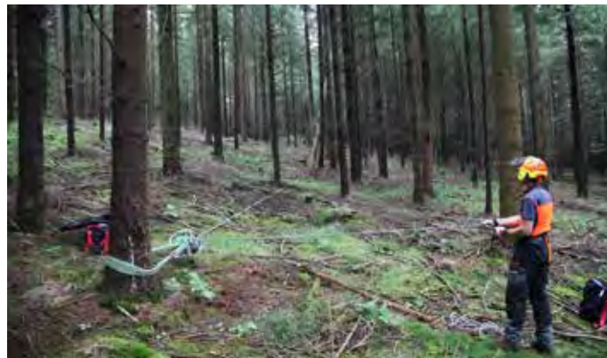
Ein sichere Alternative, wenn das Holz stimmt: Mit einer Spillwinde können hängen gebliebene Bäume unverzüglich und fachgerecht zu Fall gebracht werden.
