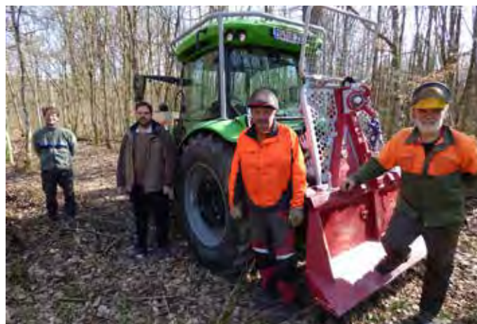
Ein sichere Alternative, wenn das Holz stimmt: Mit einer Spillwinde können hängen gebliebene Bäume unverzüglich und fachgerecht zu Fall gebracht werden.
